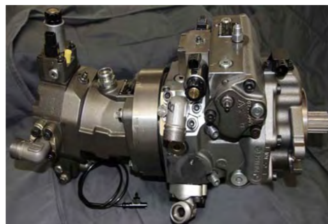
Рис. 4. Испытательный блок (тандем «блок — A4VG насос / A6VM двигатель»)
